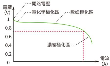
FCS3000軟體基於實測的燃料電池極化曲線，支援使用者通過.csv檔導入方式，下載到設備並實現燃料電池輸出極化特性曲線的類比。實驗中，FCS3000燃料電池類比軟體將控制系統按照極化曲線改變輸出電壓，並即時記錄電壓，電流及功率等參數，為工程師研究燃料電池推進系統提供關鍵的實驗資料。
