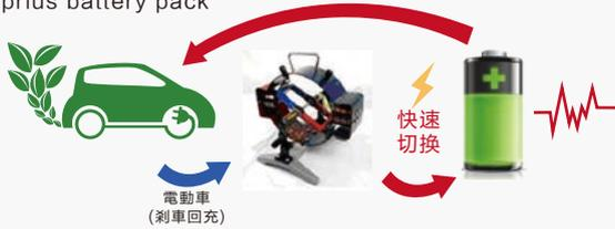
實際測試中，需要模擬電動汽車煞車回充技術，去實現高速的電流回充電池的測試，整個測試需要在10ms以內完成，所以測試儀器的速度就直接決定了是否能進行最真實的模擬。IT6500C搭載功率耗散器即可輕鬆達成。
