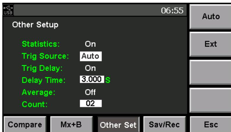
7. 設置完成後可以按[Esc]返回測量介面，如果未按[Enter]進行確認當前設置，直接按[Esc]返回則設置不成功。
