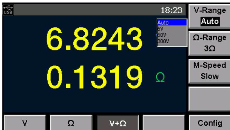
以 IT5101 機型為例，電阻量程（Ω-Range）設置圖如下所示。
