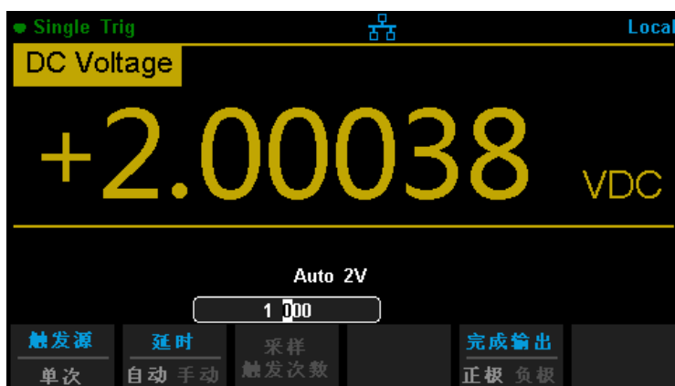
图 2- 53 触发源为单次触发的采样
