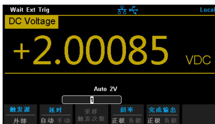
图 2- 54 触发源为单次触发的采样
