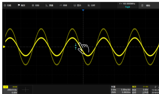
通过垂直方向的两点缩放手势控制波形的垂直档位
