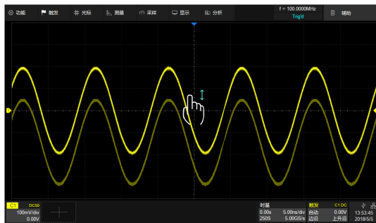
通过单点上下移动控制波形的垂直位移
